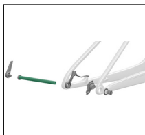
Zadní osa s univerzální patkou přehazovačky
